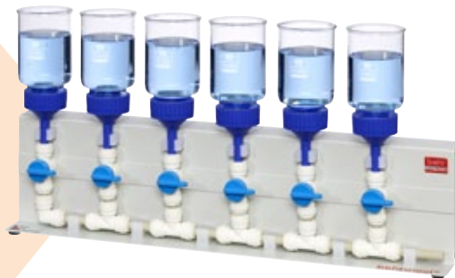
Filtriereinrichtungen für die Hydrolyse S. 18
