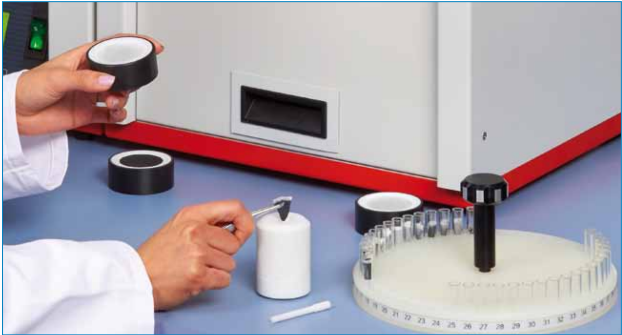
Einfache Überführung der Membranfilter in spezielle Glascontainer
