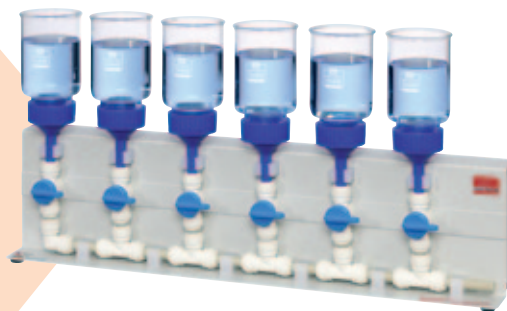
Filtriereinrichtungen für die Hydrolyse S. 18
